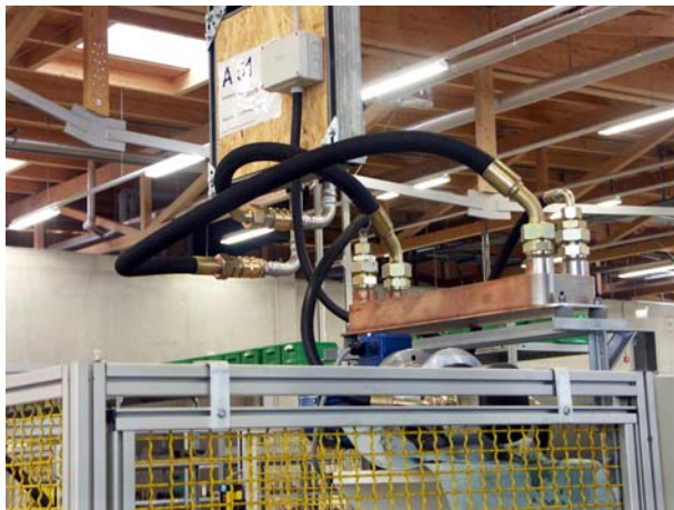
Abb. 1: Wärmeaustauscher an der Maschine (Werkbild: SANHA Kaimer GmbH & Co. KG)
